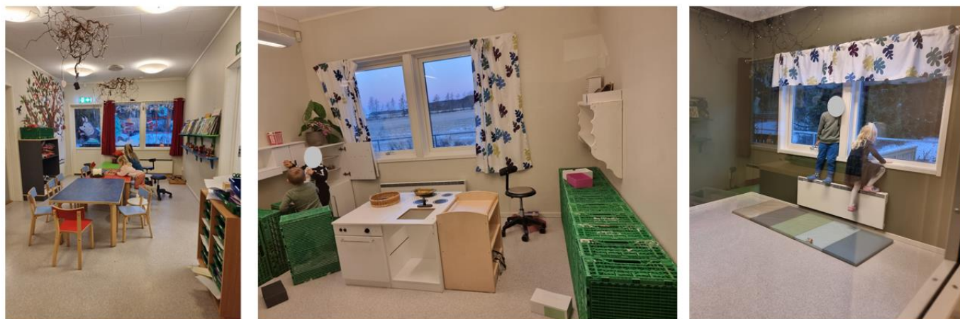
Figur 36 Bildene over viser hvordan det til tross for de funksjonelle manglene i rom, legges til rette for lek og utforskning på en god måte. Grønne kasser bør byttes ut med mer egnet bygge- og oppbevaringsmateriale. Panelovner under vindu, benyttes til klatrestativ for utsyn. Høy brystning på vinduer reduserer barns mulighet for utsyn.
