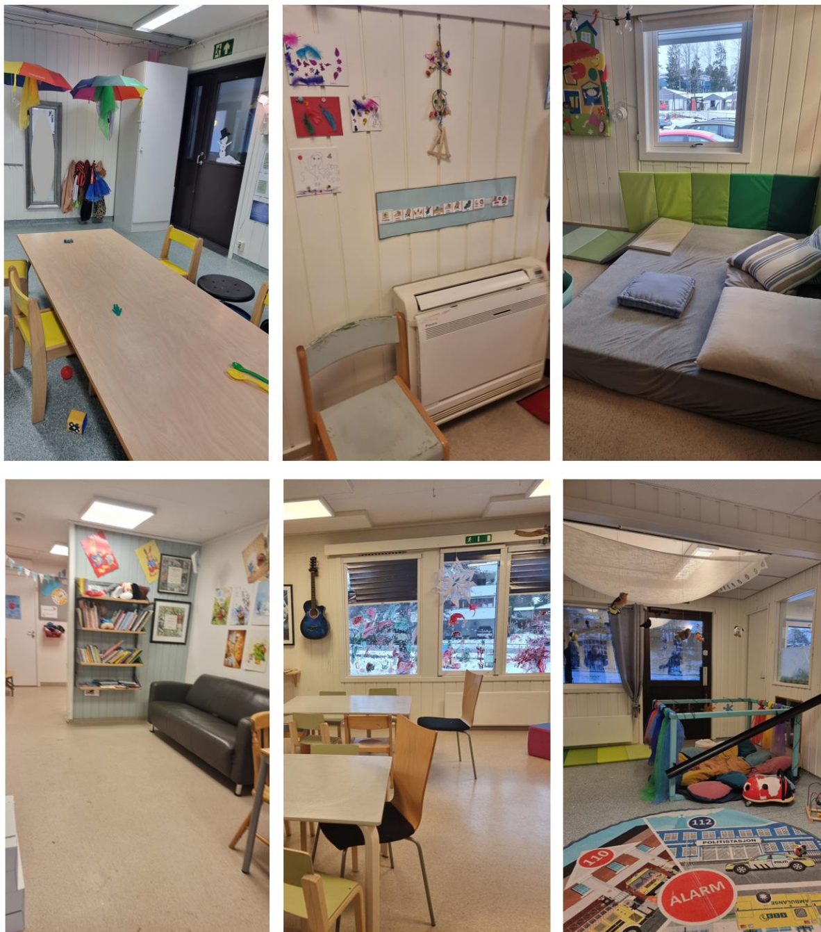
Figur 32 Bildene viser at det gjøres et godt pedagogisk arbeid for tilrettelegging av lek og kommunikasjon. Bygget og de tekniske løsningene virker negativt inn på lekemiljøet. Vinduer med høy brystning, reduserer muligheten for utsyn. Rom uten dagslys og transparens er ikke i henhold til krav til lekemiljø. Varmepumper og varmeovner lavt på vegg, begrenser mulighet for møblering og etablering av lekesoner.
