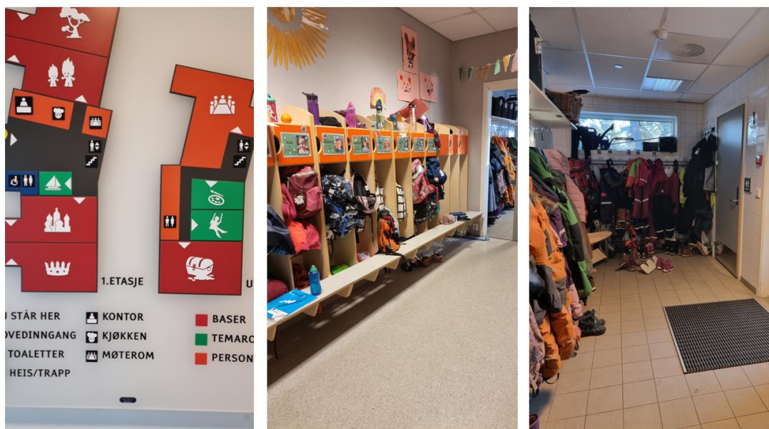
Figur 44 Bildene viser visuell og taktil skilting i barnehagens hovedinngang. Desentralisere innganger gir barn oversikt over handlingsrekkene ved påkledning og kjennskap til eget utstyr. Grovgarderobe har lite plass utenom ganglinjene og innredning. Innredning er heller ikke i stor nok grad tilrettelagt for barns medvirkning, Det er lite plass til personalets arbeidstøy i barnas garderober.
